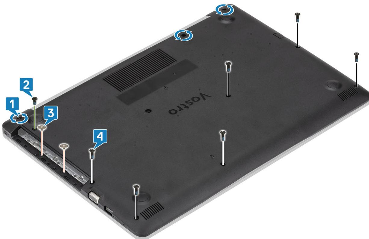
3. Faites levier sur le cache de fond pour le retirer de l'angle supérieur droit [1] et continuer à ouvrir le côté droit du cache de fond [2].
